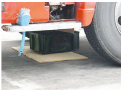
オイル交換時の油漏れ対策
