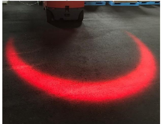
設置高さ2m、水平距離2m：アーチ幅2.5m、太さ25cm程度
