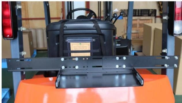
6、コの字ボルト2本を左側ピラーに取付け仮締めする。
