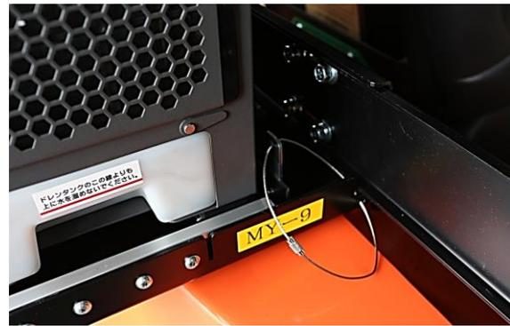
10、中間にある切欠きストッパープレートを倒し固定を確認する。
