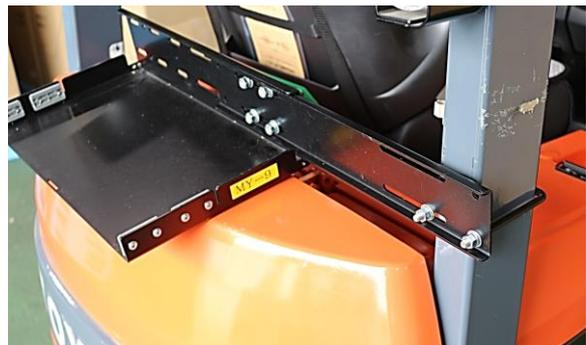
4、コの字ボルトを右側ピラーに2本取付け、仮締めする。
