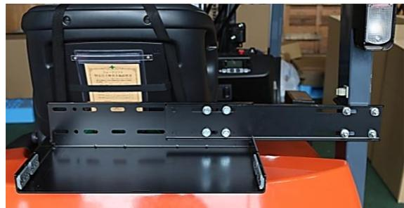
5、左側ピラーにスライドバーを調整し、位置を決めボルト4本で仮締めする。
